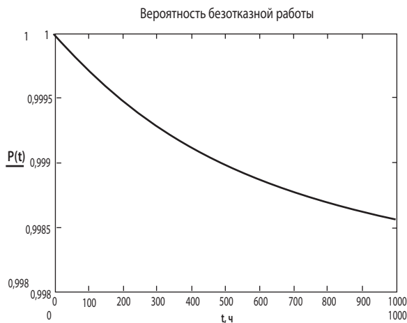
Рис. 4. Графики зависимости основных показателей надежности от времени
